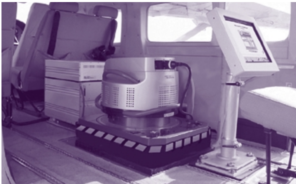
Figura 5. Sensor digital ADS40. Cortesía de Leica Geosystems.
